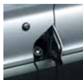
Ford Easy Fuel (Fehlbetankungsschutz) Easy Fuel (empêche les erreurs de carburant lors du plein) Easy Fuel (impedisce il rifornimento scorretto)
